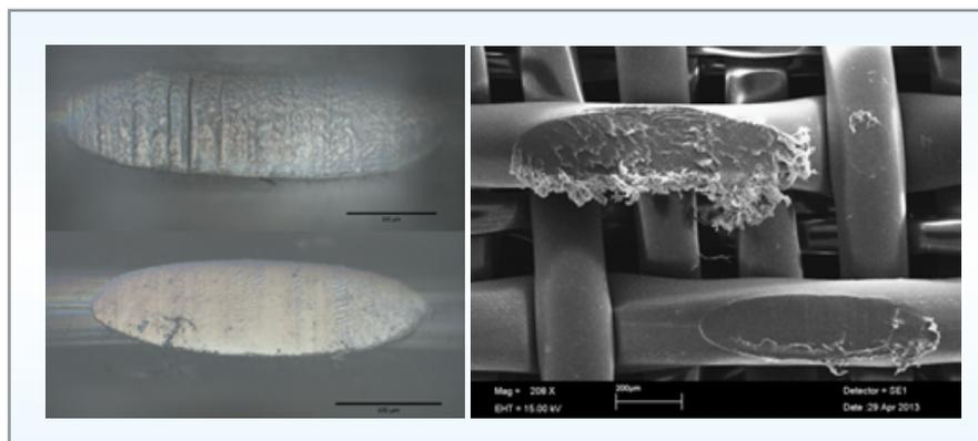
**Figura 3:** Microfotografías de microscopio electrónico (SEM) de los estándares de desgaste del PA 6 (arriba) y PET (abajo) rodando contra  $ZrO_2$ . A la izquierda, fuerza normal de 30 N, 600 rpm por 600 s. A la derecha, fuerza normal de 30 N, 600 rpm por 2400 s
