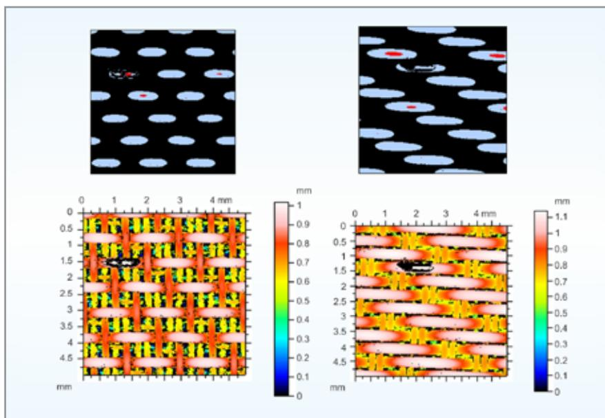
Figura 1: Área de contacto de los hilos transversales CD en telas con pasadas cortas y largas en la superficie de desgaste a una profundidad de  $100\mu\text{m}$ . Pasada corta, área de contacto de 18% (izquierda) y pasada larga, área de contacto del 26% (derecha)
