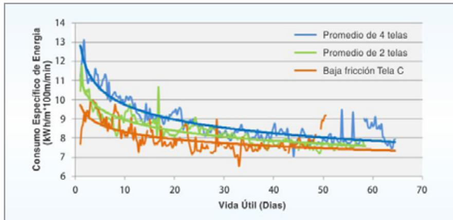
**Gráfico 3:** La relación entre el consumo específico de energía y la vida útil de la tela en una gap former de LWC de alta velocidad se la compara en tres diseños de telas formadoras. Se midió una reducción del 25% en el consumo de energía entre las telas A y C con o uso de hilos de "baja fricción" en la superficie de desgaste
