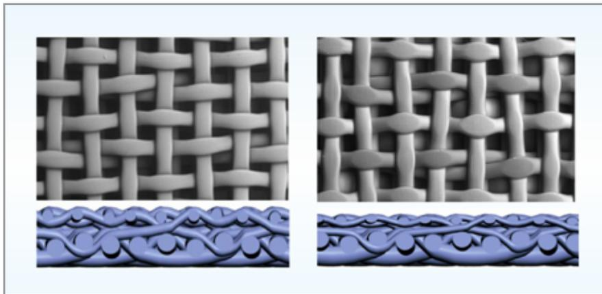
Figura 2: Imágenes de modelo de tomografía computarizada por micro rayos X, incluyendo una imagen de la sección transversal y una microfotografía aproximada por microscopio electrónico (SEM) de una muestra no tratada (izquierda) y una muestra tratada (derecha)
